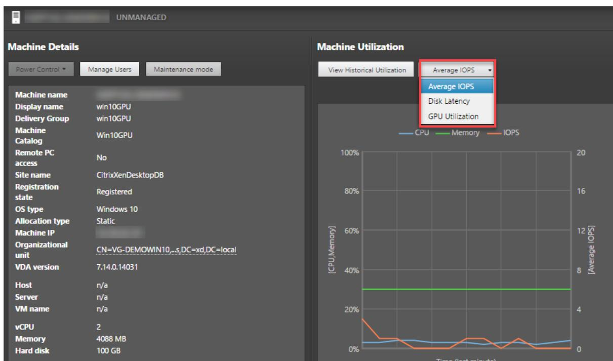
[GPU 使用率] を選択すると GPU、GPU メモリ、およびエンコーダーとデコーダーの使用率がパーセント値として表示され、サーバーまたは単一セッション OS の VDA での GPU 関連の問題を解決できます。[GPU 使用率] グラフは、NVIDIA Tesla M60 GPU を搭載した 64 ビット Windows と Display Driver バージョン 369.17 以降が実行されている VDA でのみ使用できます。
