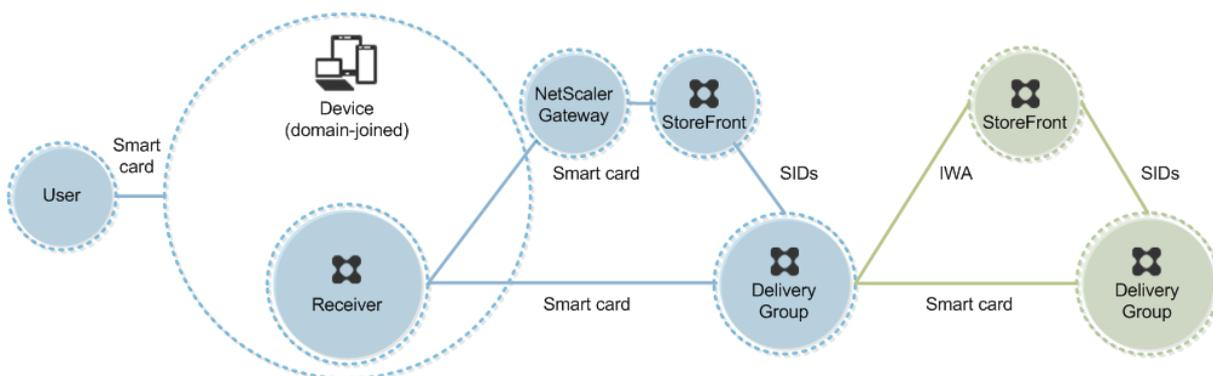
ユーザーはスマートカードと PIN を使ってデバイスにログオンし、次に Citrix Gateway/Access Gateway にもう一度ログオンします。この展開では Receiver で 2 モード認証を使用できるため、この 2 つ目のログオンではスマートカードと PIN を使用したりユーザー名とパスワードを入力したりできます。
