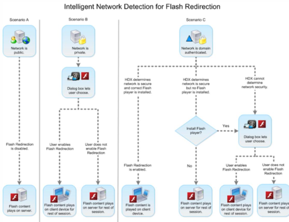
インテリジェントネットワーク検出機能は、ユーザー側で有効または無効にすることができます。これを行うには、[Citrix Workspace アプリ - Desktop Viewer 基本設定] ダイアログボックスの [Flash] タブで、[最適化する] または [最適化しない] を選択します。ここに表示されるオプションは、次の図のように、ユーザーデバイスでの Flash リダイレクトの構成により異なります。
