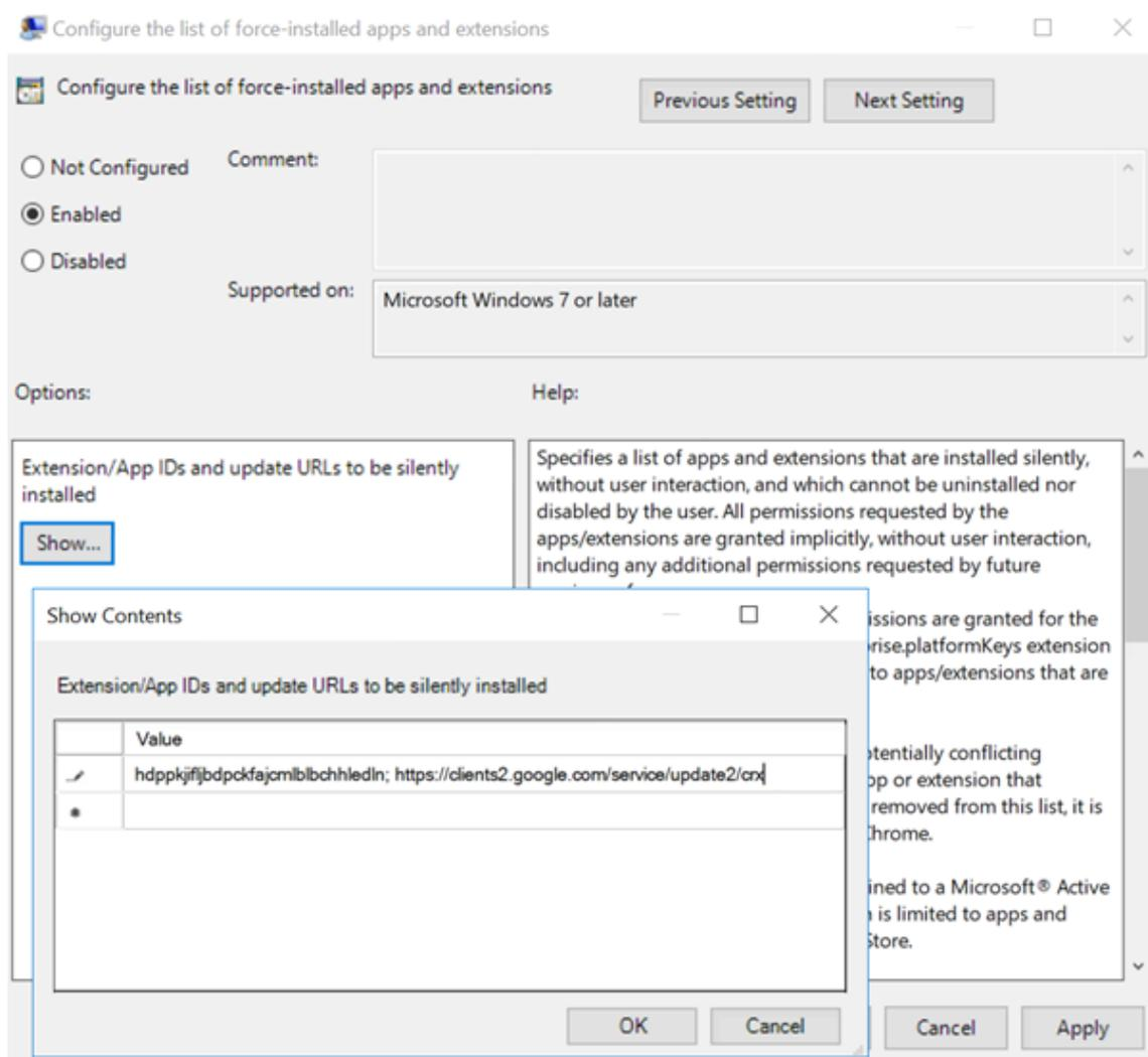
4. 設定を適用し、**gpupdate** が更新されると、ユーザーへこの拡張機能が自動で配信されます。ユーザーのセッションで Chrome ブラウザーを起動すると、この拡張機能がすでに適用されています。ユーザーがこの機能を削除することはできません。
