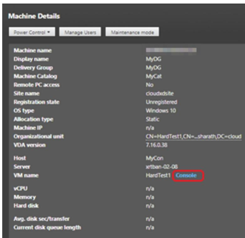
マシンのトラブルシューティングを行うには、対応する [マシンの詳細] パネルで [コンソール] リンクをクリックします。提供したホスト資格情報が認証されると、Web ベースの VNC クライアントである noVNC を使用して、別のタブでマシンコンソールが開きます。これで、キーボードとマウスでコンソールにアクセスできるようになりました。
