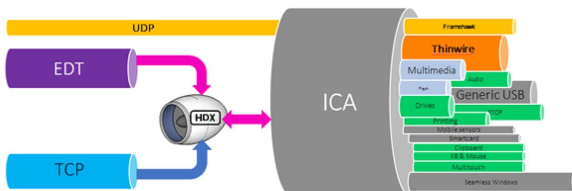
【優先】に設定すると、EDT 経由のデータ転送がプライマリとして使用され、TCP にフォールバックします。Windows 向け Citrix Workspace アプリバージョン 1808 以降または Citrix Receiver for Windows バージョン 4.10 以降、およびセッション画面の保持機能を有効にすると、初期接続、セッション信頼性再接続、および自動クライアント再接続中に EDT と TCP が同時に試行されます。そうすることで、EDT 設定が【優先】であるにもかかわらず、必要な基礎となる UDP トランスポートが利用できなくなり、TCP を使用する必要がある場合に、接続時間が短縮されます。デフォルトでは、TCP にフォールバックした後、アダプティブトランスポートは 5 分ごとに EDT を検索し続けます。
