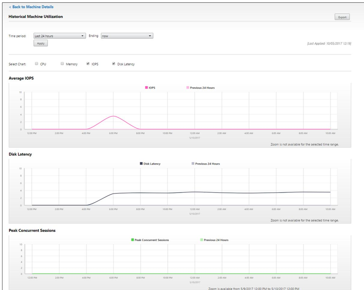
たとえば、[過去 2 時間] を選択すると、基準の期間は選択した時間範囲の 2 時間前になります。過去 2 時間と基準期間の CPU、メモリ、およびセッションの傾向を表示します。[過去 30 日間] を選択すると、基準期間は先月になります。これを選択すると、先月から基準日時までの平均 IOPS およびディスク遅延が表示されます。
