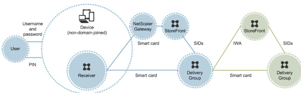
ユーザーがデバイスにログオンします。通常はユーザー名とパスワードを入力しますが、デバイスがドメインに参加していないため、このログオンでの資格情報の入力必須ではありません。この展開では 2 モード認証を使用できるため、Receiver ではスマートカードと PIN、またはユーザー名とパスワードのいずれかの入力が必要です。その後、Receiver が Storefront への認証を実行します。
