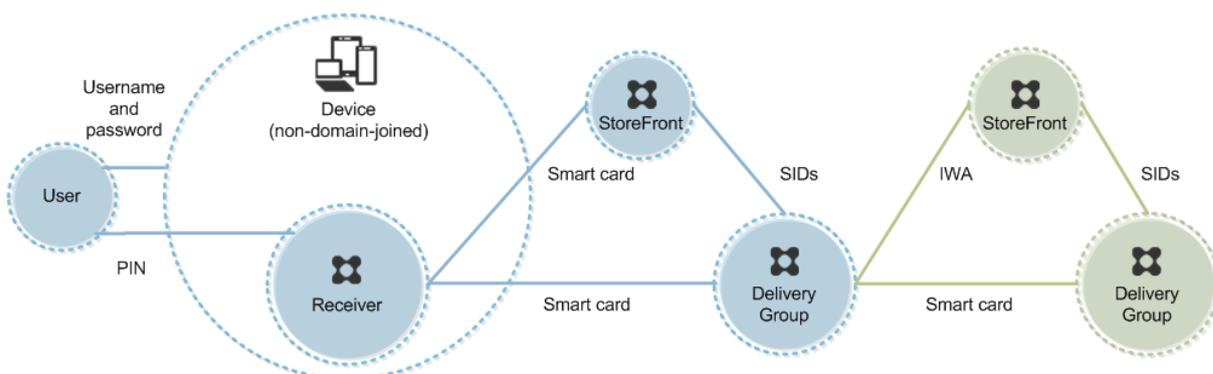
ユーザーがデバイスにログオンします。通常はユーザー名とパスワードを入力しますが、デバイスがドメインに参加していないため、このログオンでの資格情報の入力必須ではありません。この展開では 2 モード認証を使用できるため、Receiver ではスマートカードと PIN、またはユーザー名とパスワードのいずれかの入力が必要です。その後、Receiver が Storefront への認証を実行します。
