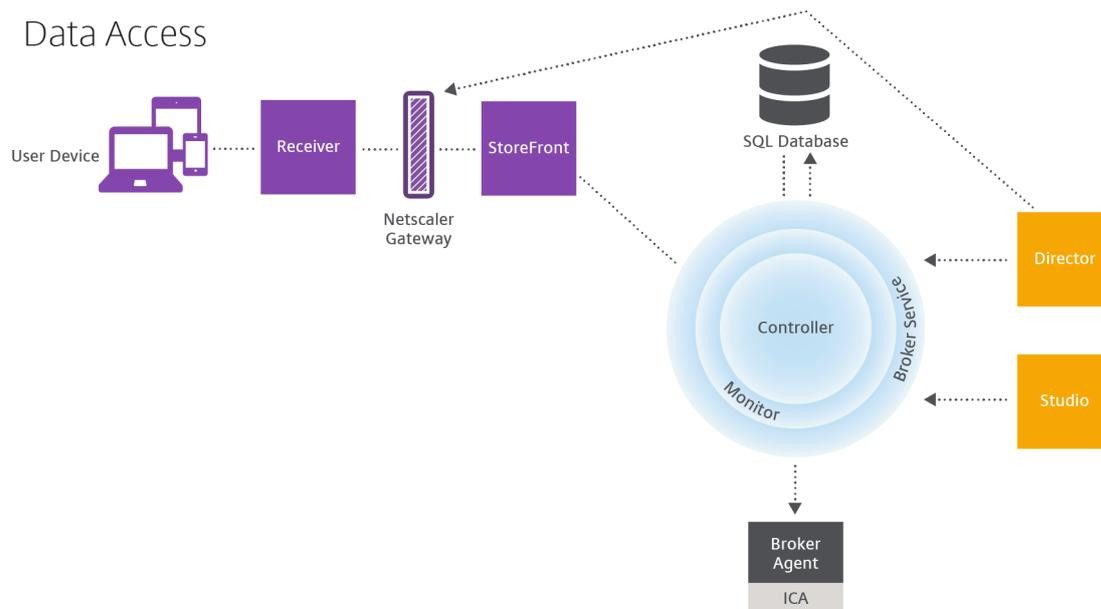
Controller 内では、Broker Service がリアルタイムデータを提供するマシン上の各セッションについてのセッションデータをレポートします。Monitor Service もこのリアルタイムデータを監視して、履歴データとして監視データベース内に格納します。
