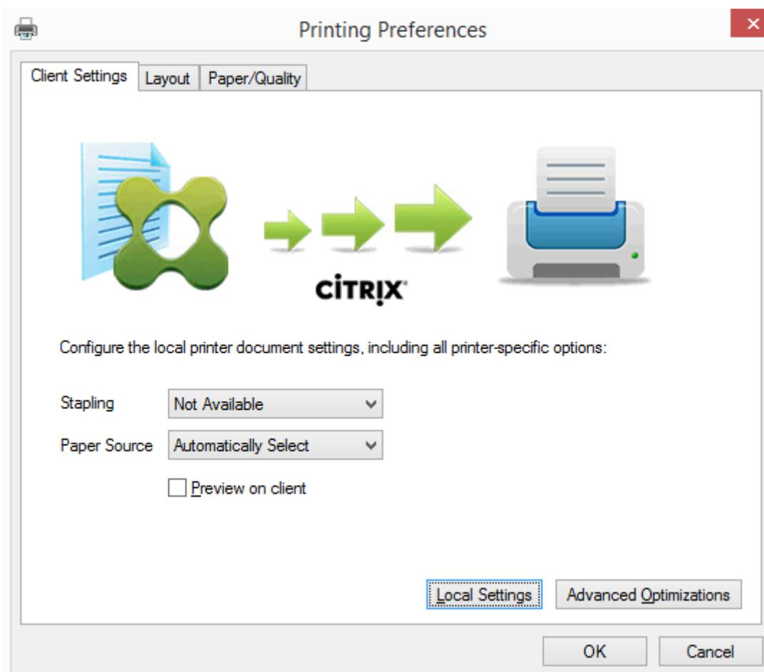
ホチキス留めや安全な PIN などの非標準のプリンター設定を設定するには、Citrix UPD EMF または XPS ドライバーを使用するあらゆるクライアントマッピングされたプリンターに対して、カスタムの UPD 印刷ダイアログで [ローカル設定] を選択します。マップされたプリンターの [プリンターの設定] ダイアログがクライアント上のセッションの外部に表示されるので、ユーザーはあらゆるプリンターオプションを変更でき、アクティブなセッションでそのドキュメントを印刷する場合、変更されたプリンター設定が使用されます。
