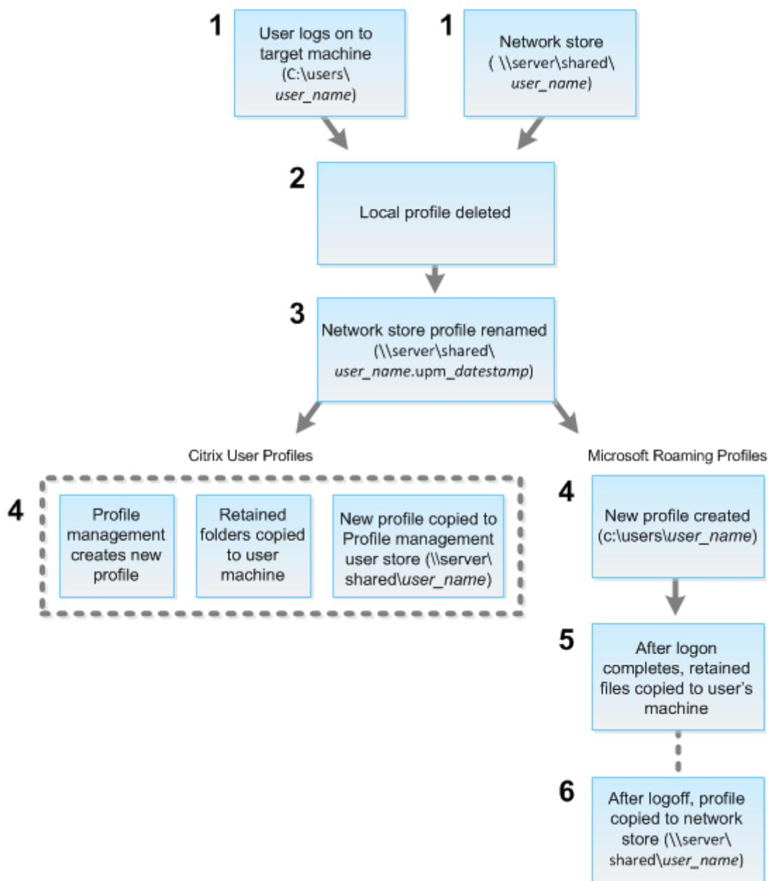
Director からのリセットコマンドにより、プロファイルの種類が指定されます。次に、Profile management サービスによりその種類のプロファイルのリセットが試行され、適切なネットワーク共有（ユーザーストア）が検出されます。Profile management により処理されたユーザーのプロファイルに対して移動プロファイル用のコマンドが発行された場合は拒否されます（逆の場合も同様）。
