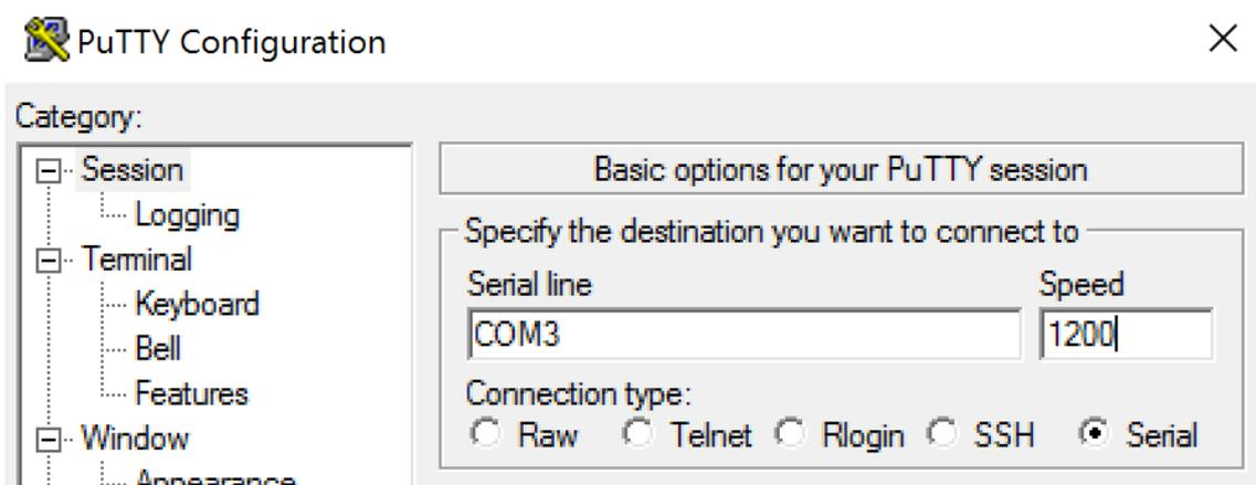
ローカルのコマンドウィンドウで **MODE** コマンドを実行すると、その出力に、使用中の COM ポート、および PuTTY セッションに必要なボーレート/パリティ/データビット/ストップビットの情報が表示されます。PuTTY 接続に成功した場合は、**Enter** キーを押すとデバイスからのフィードバックが表示されます。入力した文字が画面上で繰り返されるか、または応答が返されます。この手順が正常に行われない場合、仮想セッションからデバイスにアクセスすることはできません。
