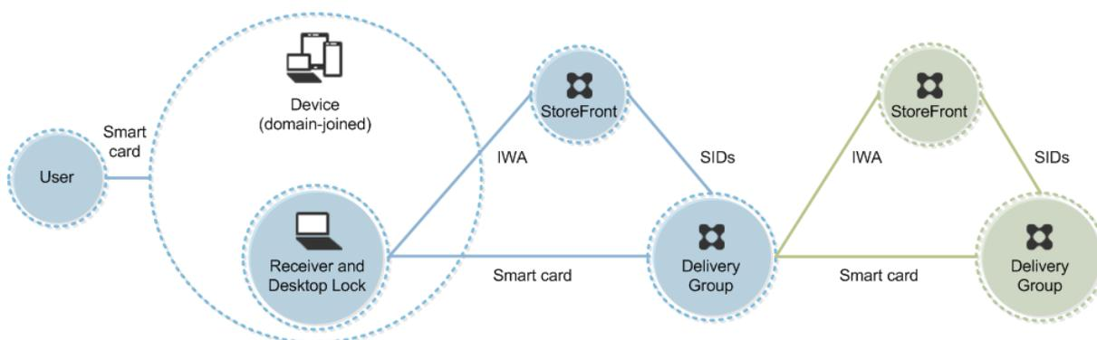
ユーザーは、スマートカードと PIN を使ってデバイスにログオンします。Receiver は、StoreFront サーバーにアクセスするユーザーを統合 Windows 認証 (IWA) で認証します。StoreFront により、ユーザーのセキュリティ識別子 (SID) が Citrix Virtual Apps または Citrix Virtual Desktops に渡されます。Receiver でシングルサインオン機能が構成されているため、ユーザーが仮想デスクトップやアプリケーションを起動するときに PIN を再入力する必要はありません。
