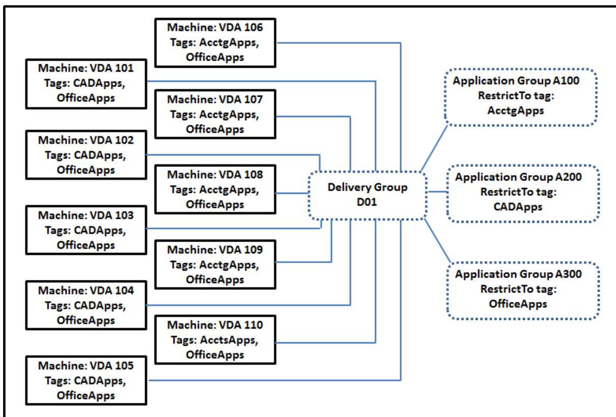
この例では、10 台のマシン (VDA 101～110)、1 つのデリバリーグループ (D01)、および 3 つのアプリケーショングループ (A100、A200、A300) を使用します。各アプリケーショングループの作成時に、各マシンにタグを適用し、タグ制約を指定することにより、以下のことが可能です。
