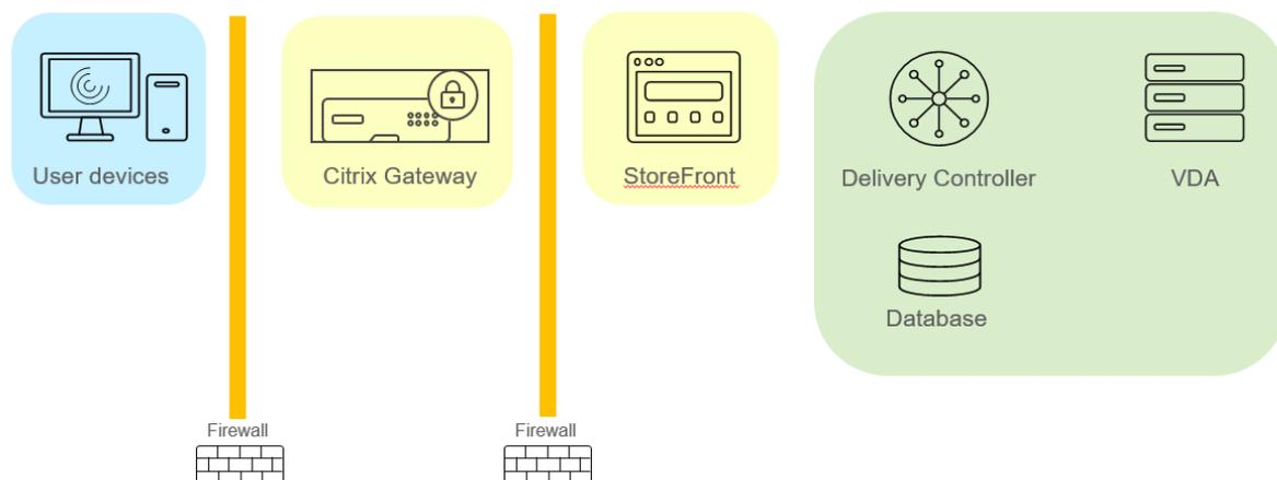
ユーザーは、Citrix Gateway を使用してログオンおよび認証を行います。Citrix Gateway は、DMZ で展開およびセキュリティ保護されます。2 要素認証が構成されます。ユーザーの資格情報に基づいて、ユーザーに該当のリソースおよびアプリケーションが提供されます。アプリケーションとデータは適切なサーバー上に存在します（図には表示されていません）。セキュリティ上機微なアプリケーションとデータについては、別のサーバーが使用されます。
