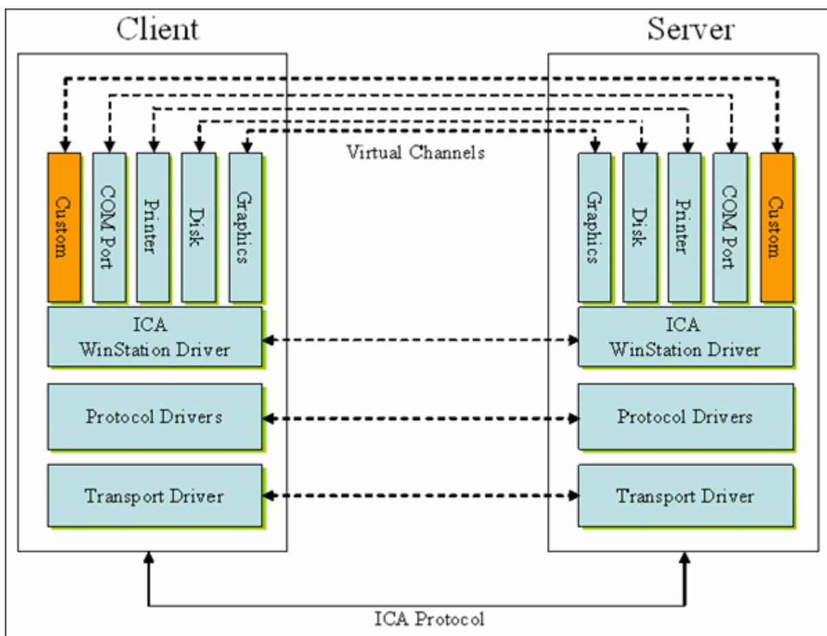
仮想チャンネルは、サーバー側のアプリケーションと通信するクライアント側の仮想ドライバーで構成されます。Citrix Virtual Apps and Desktops には、さまざまな仮想チャンネルが含まれています。提供されている各種ソフトウェア開発キット（SDK）のいずれかを使用して、ユーザーやサードパーティベンダーが独自の仮想チャンネルを作成できるように設計されています。
