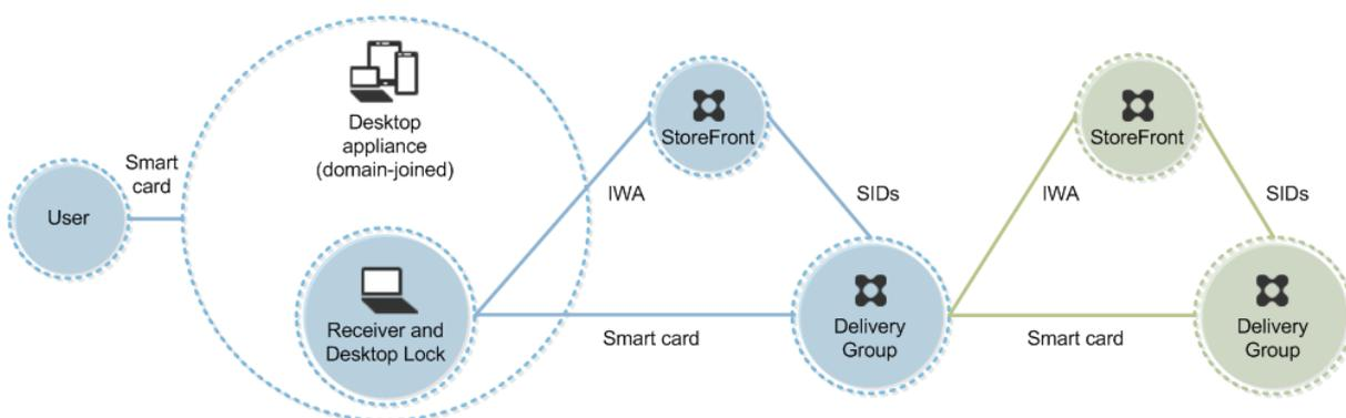
ユーザーは、スマートカードと PIN を使ってデバイスにログオンします。デバイス上で Desktop Lock が動作している場合は、StoreFront サーバーでのユーザー認証に統合 Windows 認証 (IWA) が使用されます。StoreFront により、ユーザーのセキュリティ識別子 (SID) が Citrix Virtual Apps または Citrix Virtual Desktops に渡されます。Receiver でシングルサインオン機能が構成されているため、ユーザーが仮想デスクトップを起動するときに PIN を再入力する必要はありません。
