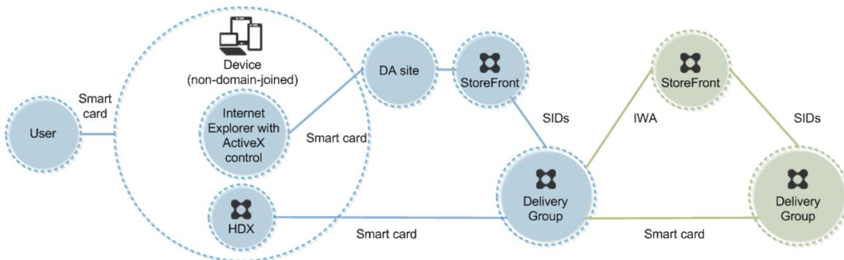
ユーザーは、スマートカードを使ってデバイスにログオンします。Desktop Lock を実行するデバイスは、キオスクモードで動作する Internet Explorer を介してデスクトップアプライアンスサイトを起動するように構成されます。サイトの ActiveX コントロールにより PIN の入力が求められ、それが StoreFront に送信されます。StoreFront により、ユーザーのセキュリティ識別子 (SID) が Citrix Virtual Apps または Citrix Virtual Desktops に渡されます。割り当てられたデスクトップグループ一覧で使用可能な (アルファベット順で) 最初のデスクトップが起動します。
