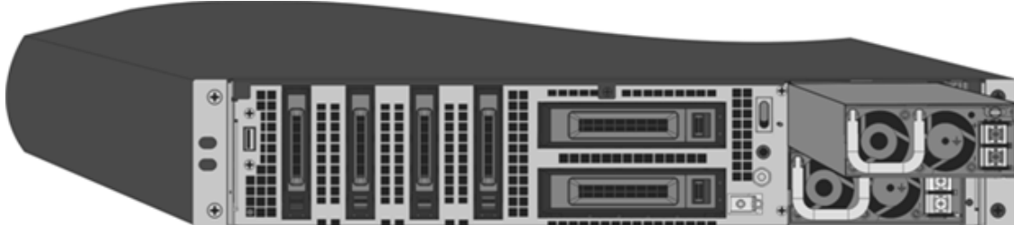
図 4: 交換用 DC 電源装置の挿入
